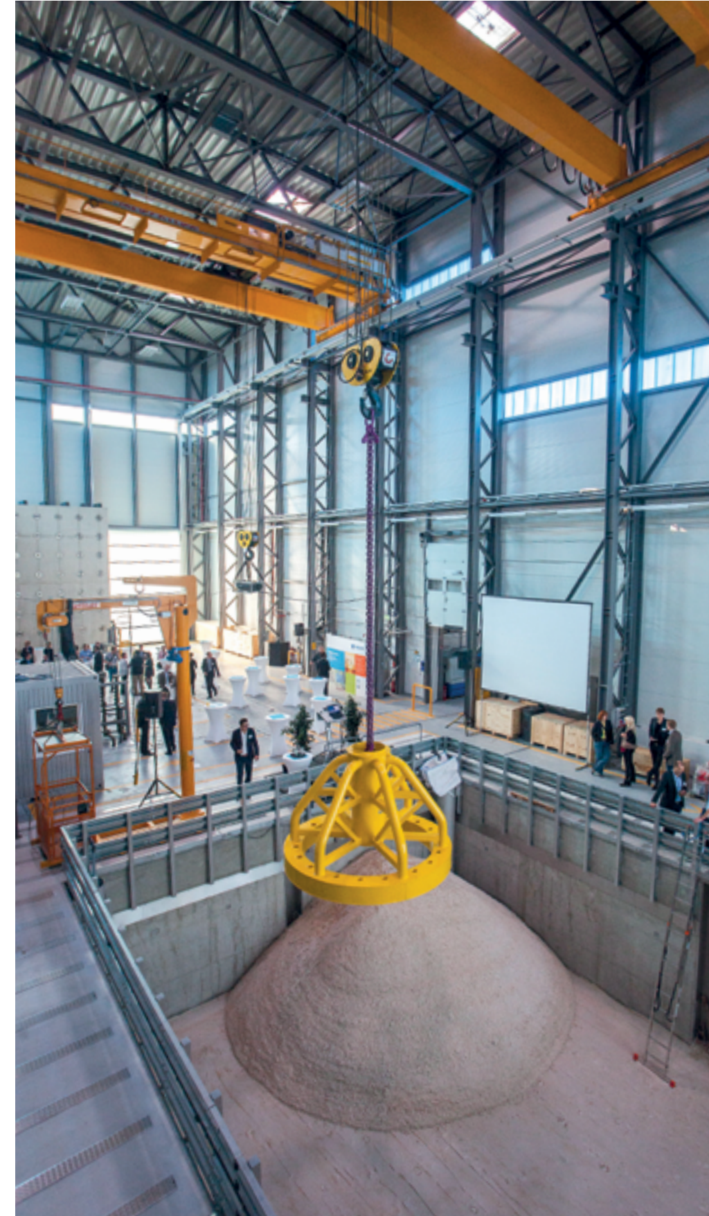
Das Testzentrum für Tragstrukturen in Hannover-Marienwerder ist ein Kooperationsprojekt der Leibniz Universität Hannover und dem Fraunhofer-Institut für Windenergie und Energiesystemtechnik. 2014 fertiggestellt, steht das Testzentrum mit seinen zwei europaweit einzigartigen Großversuchsgeräten der Forschung und Unternehmen für die Prüfung von Tragwerken von Onshore- und Offshore-Windenergieanlagen zur Verfügung. Das Testzentrum wurde u.a. mit Unterstützung des Bundesministeriums für Wirtschaft und Energie und dem Europäischen Fonds für regionale Entwicklung (EFRE) errichtet. Die Netto-Grundfläche (NGF) beträgt 2.110 m 2 bei einer Brutto-Grundfläche (BGF) von 2.395 m 2 und einem umbauten Raum (BRI) von 26.000 m 3 .
